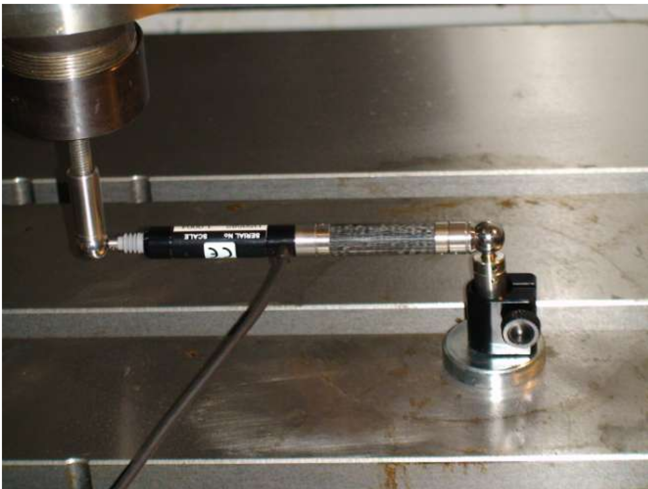
Рисунок – 36 Установка датчика на станке
