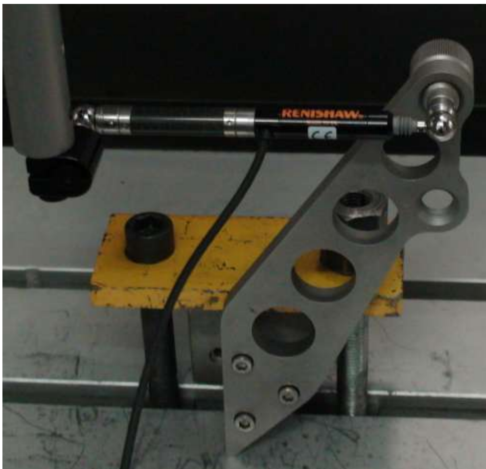
Рисунок – 40 Устанок кронштейна на станке для проверки в плоскости XZ
