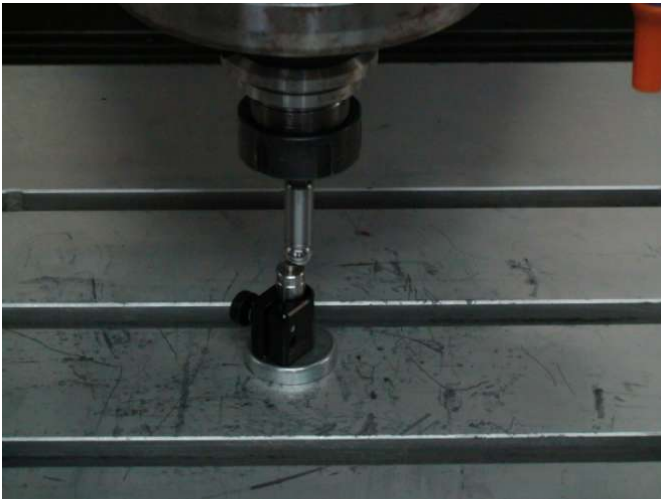
Рисунок -34 Подвод оправки к магнитной опоре.
