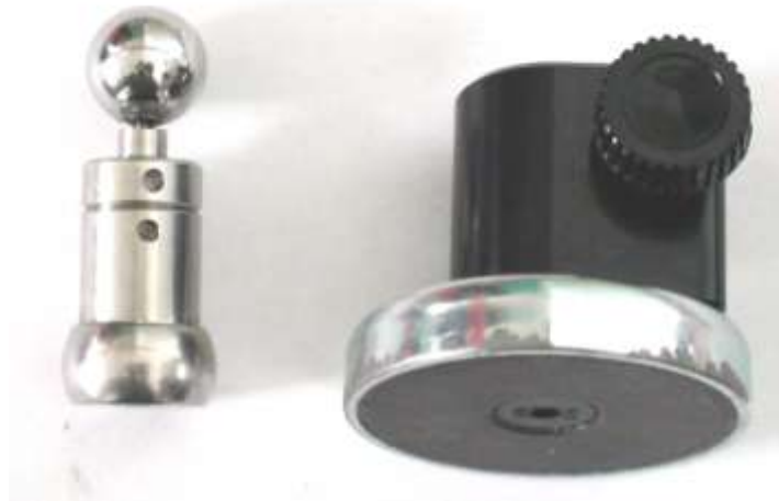
Рисунок 28 - Магнитная опора (справа) и шариковая опора (слева).
