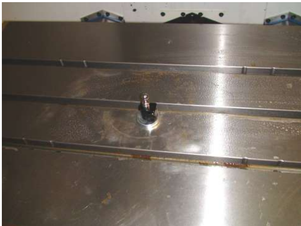
Рисунок 29 - Магнитная опора со вставленной шариковой опорой на столе станка.
