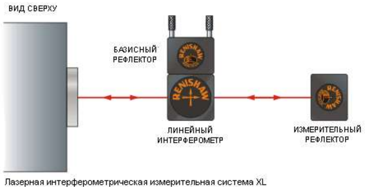
Рисунок 25 - Горизонтальные оси: подвижный интерферометр или подвижный рефлектор
