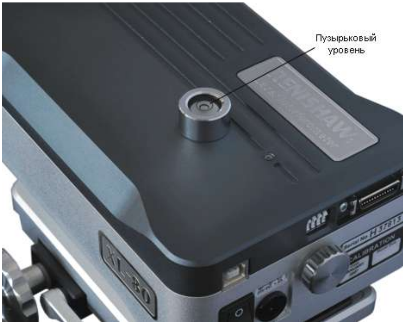
Рисунок 12 - Пузырьковый уровень, установленный сверху на лазерную головку системы XL80
